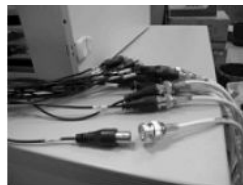
Fig. 2—3 Conexión de las cámaras a los conectores BNC
