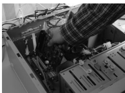
Fig. 2—1 Instalación de la tarjeta capturadora de video
